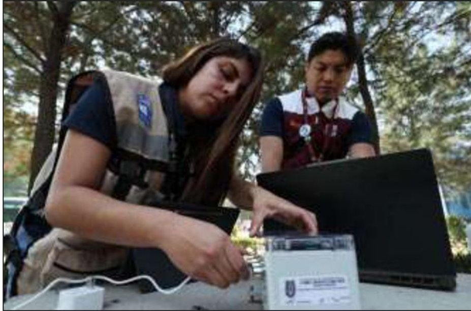
Un equipo académico de la ESIA Unidad Ticomán desarrolló la Red Acelerométrica, la cual registra y analiza la vibración constante del terreno.
