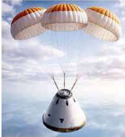
Se despliegan primero los paracaídas de frenado y luego los principales para desacelerar la nave.
