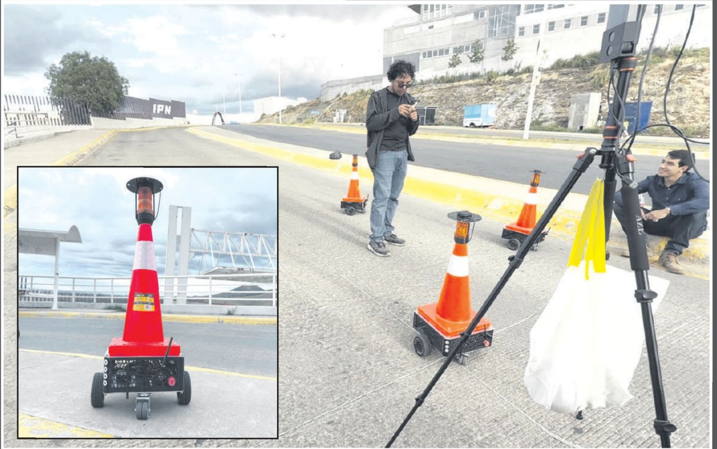
El prototipo de los egresados del IPN permite ordenar los conos vía remota, con un teléfono celular, para que bloqueen un carril o marquen un perímetro de protección.
