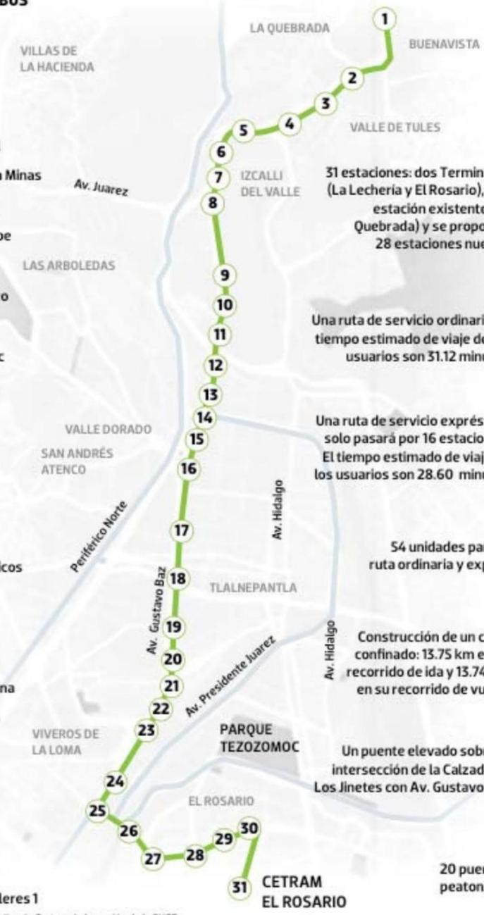
31 estaciones: dos Terminales (La Lechería y El Rosario), una estación existente (La Quebrada) y se proponen 28 estaciones nuevas
