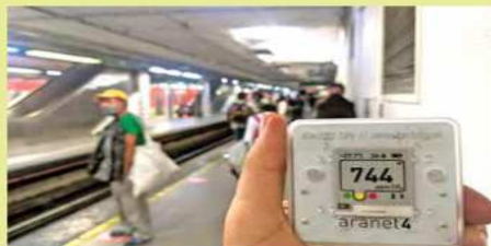
En los pasillos y andenes, que son espacios menos cerrados, las concentraciones de CO2 detectadas son menores.
